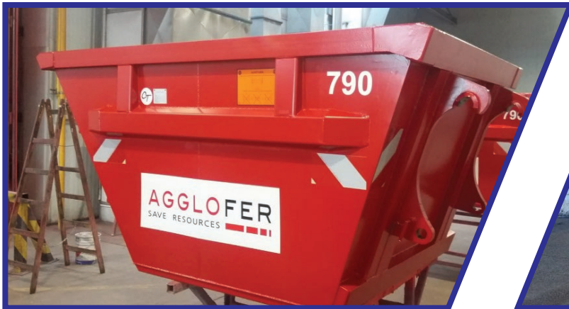
Obrázok 8. Mobilný kontajner s rýchlopínacími hákmi na stavebnú súť
