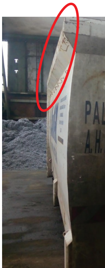
Obrázok 3. kontajner z ocele HARDOX450, vrátane lemu – žiadne prehnutie
